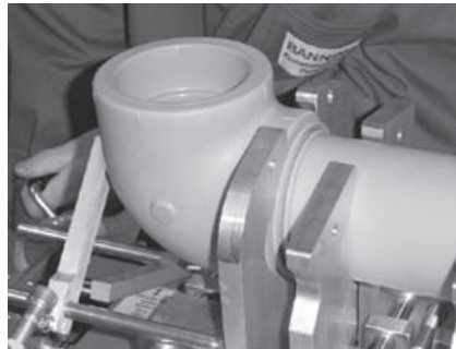
Abb. 11 Maschinenschlitten bis Hubende zusammenfahren
