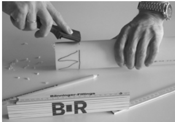
Die Oberfläche der Schweißzone mit einer Ziehklinge oder einem Schälwerkzeug spanabhebend bearbeiten
