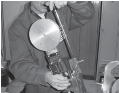
Abb. 1 Schweißspiegel in Haltevorrichtung einsetzen.
