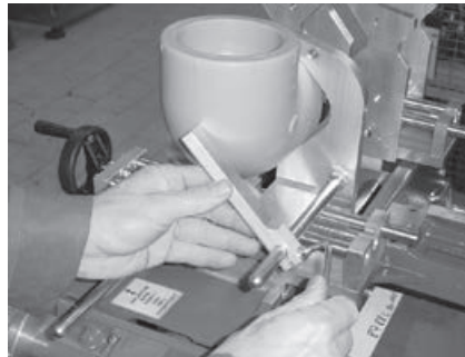
Abb. 7 Anschlag zum Halten des Fittings arretieren
