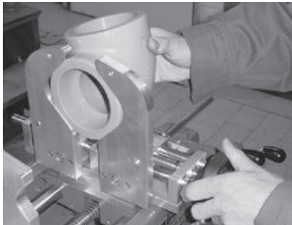
Abb. 6 Fitting in Spannbacke einlegen und arretieren
